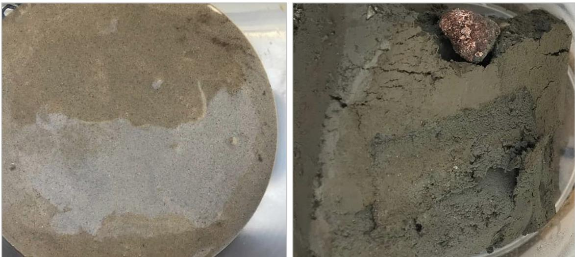
Abb. 17: Sande des Hauptgrundwasserleiters (links), Geschiebemergel (rechts)
