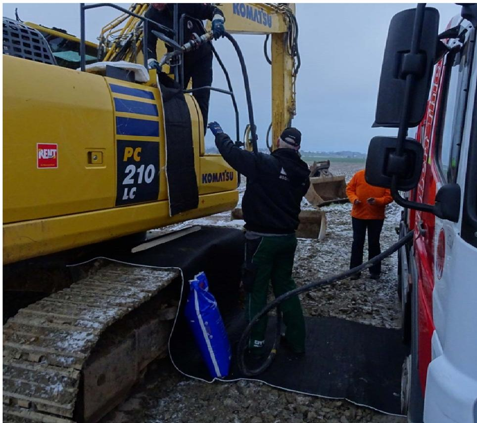
5. Die eingesetzten Geräte (insbesondere Bagger) sind vor dem Einsatz auf dieser Baustelle zu reinigen. Dabei sind insbesondere die Schmiermittelreste zu entfernen.
