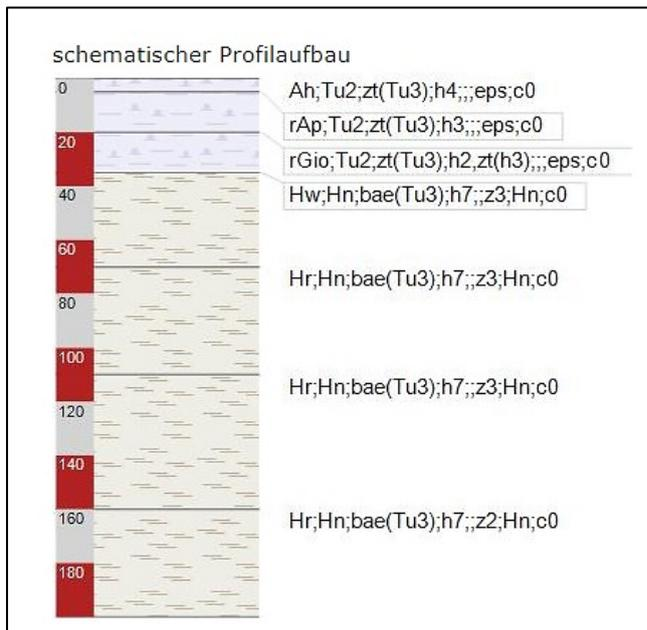
Abb. 1: Bodenprofil der Kompensationsfläche mit 35 cm toniger Marschendecke über tiefem Niedermoor.
