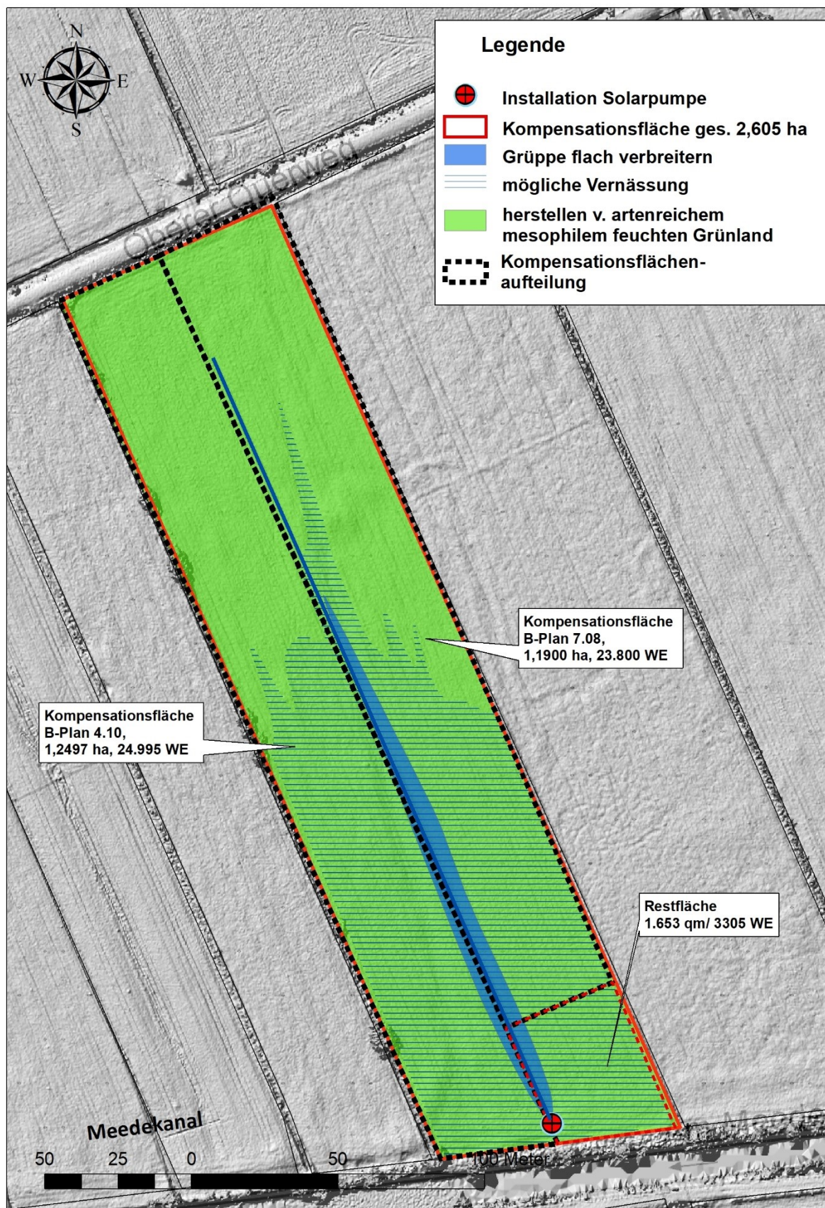
Abb. 25: Aufteilung der Kompensationsflächen mit Kompensation für ein weiteres Baugebiet (B-Plan 7.08).
