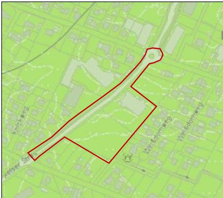
Nach dem Kartenserver NIBIS ist die Grundwasserstufe im Geltungsbereich als „sehr tief“ mittlerer Grundwasserhochstand (MHGW) > 8 – 16 dm und der mittlerer Grundwassertiefststand (MNGW) > 16 - >= 20 dm „eingestuft.“
